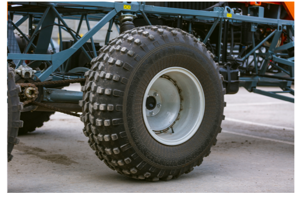
Шины низкого давления позволяют минимизировать нагрузку на почву и машину. С ними машина может развить максимальную скорость на поле до 35 км/ч.
