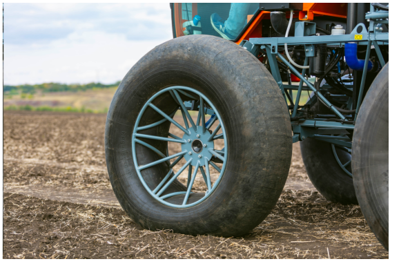
Шинодождички не имеют протектора и не подрезают всходы даже на влажной земле. Максимальная скорость до 40 км/ч.
