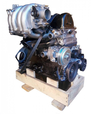
Туман-М Бензиновый инжекторный двигатель BA3-2123 Номинальная мощность 59 кВт Крутящий момент до 127,5 Н*м
