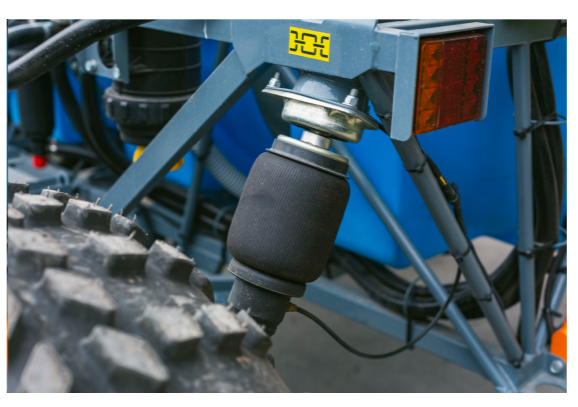
Лифтоподвеска адаптируется к весу машины, позволяя ей легко и быстро перемещаться по переменной местности.
